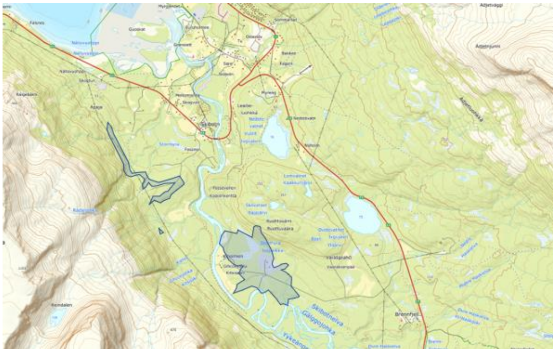
Figur 7: Konsentrasjonskart for oktober måned (meteorologi for 2018-2022). Områder som får konsentrasjon over 1 \text{ OUE/m}^3 for maksimal månedlig 99% timesverdi (som tilsvarer over 7 timer i måneden med konsentrasjon over 1 \text{ OUE/m}^3 ) er vist med blå skravur.
